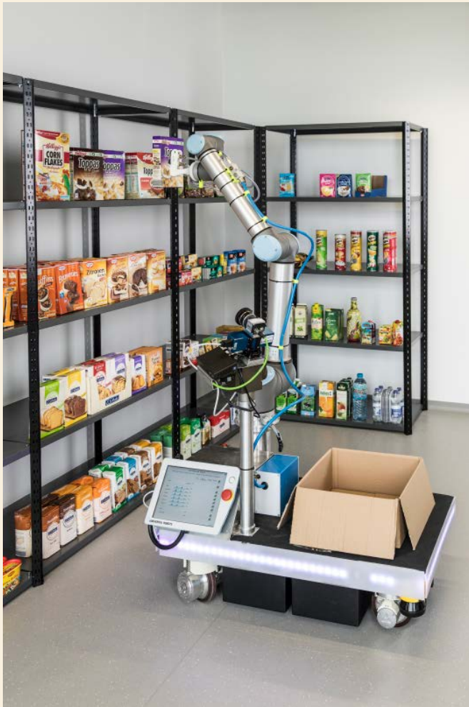
Einkaufen auch nach Ladenschluss? Dieser Roboter – eine Entwicklung des Fraunhofer IPA – soll es möglich machen. Er fährt nachts durch den Laden und packt das Bestellte ein.
